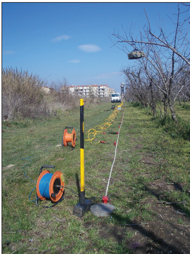
Foto 1: fase di esecuzione della prospezione sismica M.A.S.W., elemento portante dell'analisi sismica eseguita.
